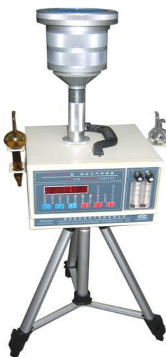
图 12-5 大气采样器示意图
