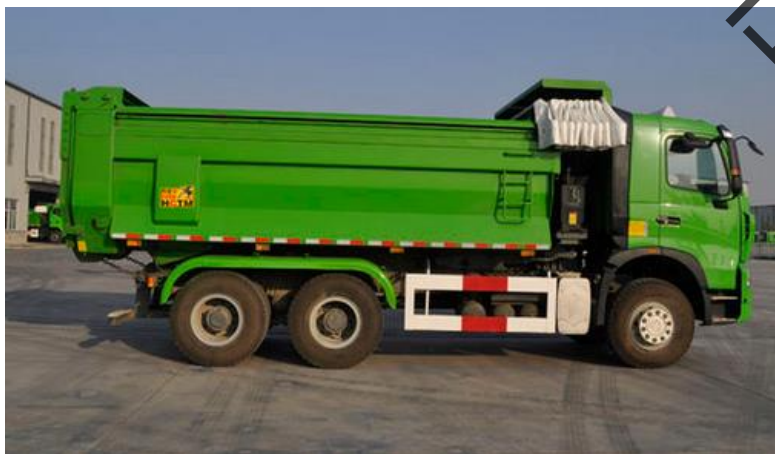
图 3-4 平滑式箱盖装置全密闭渣土车
